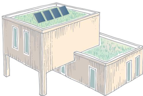
Sur une toiture plate ou végétalisée, privilégier une implantation des capteurs en un ou plusieurs bandeaux, centrée sur la toiture, positionnée à distance des rebords de toitures, avec une inclinaison de 30°.
