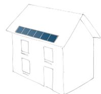
Si le nombre de capteurs est insuffisant les axer et les centrer par rapport aux fenêtres. Les capteurs sont positionnés à l'égout du toit ou au niveau du faîtage.
