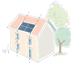
Selon les cas, regrouper les capteurs en un seul élément de forme rectangulaire, axé sur les ouvertures de façade, et positionné en pied de toit.
